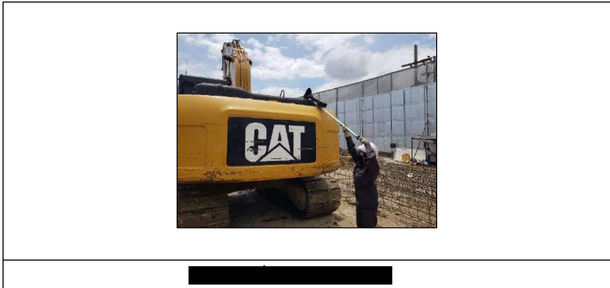
ภาพที่ 5-1 (ต่อ) การตรวจวัดปริมาณควันดำจากยานพาหนะ
